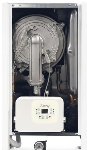
Il principale punto di forza è uno scambiatore in acciaio inox, formato da un'unica spirale, con passaggi opportunamente dimensionati, alloggiato all'interno di un involucro di acciaio inox chiuso da un frontale in alluminio e un fondo in tecnopolimero. Il bruciatore premix garantisce ottimi rendimenti di combustione e bassissime emissioni di NOx. Un ampio rapporto di modulazione consente di adattare la potenza della caldaia alle effettive esigenze dell'impianto.
