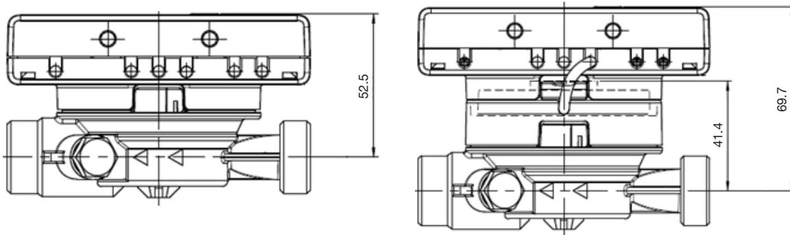
(A destra: versione con unità elettronica separabile)
