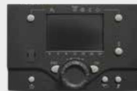
L'elettronica consente di impostare fino a 3 set-point di temperatura consentendo la riduzione notturna con possibilità di programmazione giornaliera. Per i sistemi in cascata è sufficiente l'utilizzo di un modulo di gestione che permette la comunicazione tra le caldaie installate in batteria, mentre la centralina di serie gestisce in autonomia l'impianto.
